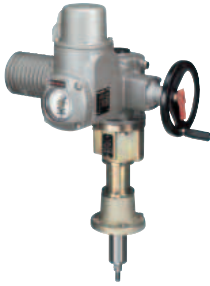
Linjärenhet LE med flervarvs ställdon SA Ställkraft från 4 kN - 217 kN Slaglängd < 500 mm Ställhastighet från 20 - 360 mm/min
