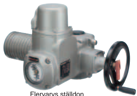
Flervarvs ställdon SA 07.1 – SA 16.1 / SA 25.1 – SA 48.1 Vridmoment från 10 - 32 000 Nm Utgående varvtal 4 - 180 rpm
